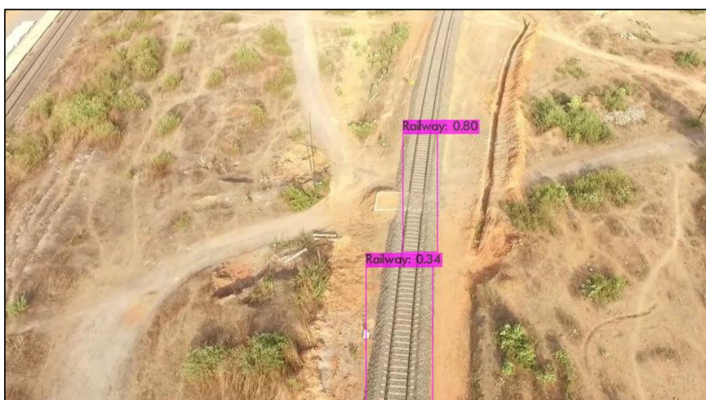
شکل ۲۳. نمونه خروجی شبکه یولو در شبکه ریلی در جهت تشخیص ماسه های بادی
