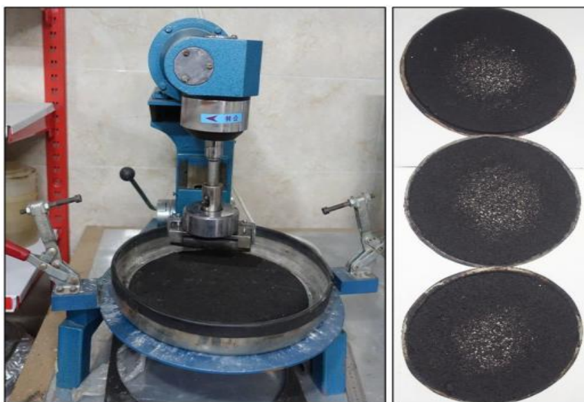
شکل ۴. نمایی از دستگاه آزمایش WTAT و نمونه‌های آن
