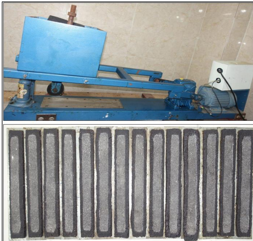
شکل ۵. آزمایش چرخ بارگذاری-چسبندگی ماسه و نمونه‌های آن
