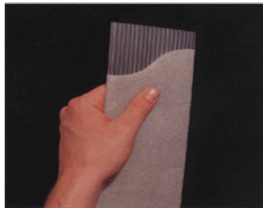
شکل ۲. نمای مقطع عرضی زهکش قائم پیش ساخته
