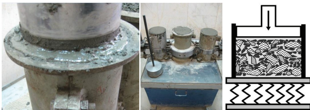
شکل ۳. ساخت و تراکم نمونه استوانه ای بتن غلتکی توسط میز لرزان و سربرار
