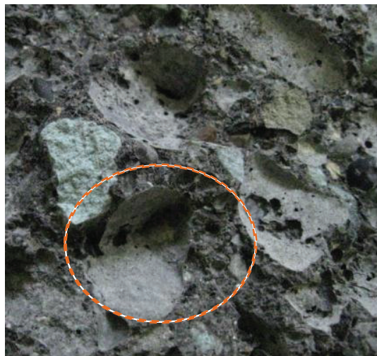
شکل ۷. نمونه هایی از انتقال ترک به دور سنگدانه های خرده آسفالت بازیافتی در مخلوط بتن غلتکی
