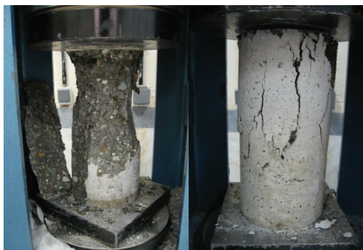
شکل ۴. آزمایش مقاومت فشاری تک محوری
